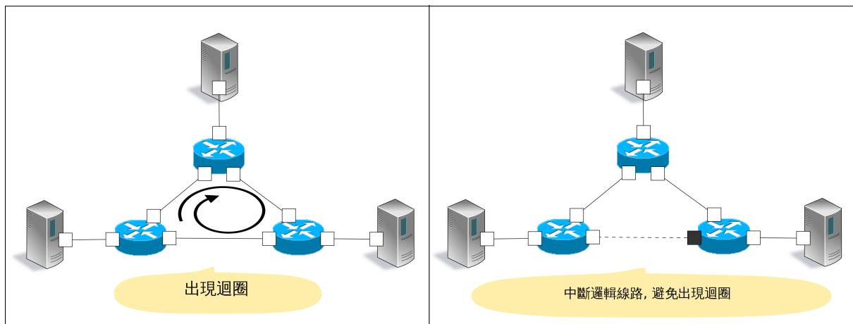
STP 會在橋接器之間交換 BPDU (Bridge Protocol Data Unit) 封包，分析及比對橋接器之間的連接埠訊息，決定哪些連接埠可以傳送哪些不行。
