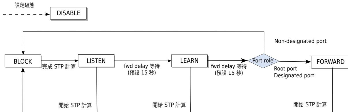
當這些程序在每一台橋接器開始執行之後，進行連接埠傳送封包或抑制封包的決定，如此一來便可以防止迴圈在網路拓墣中發生。
