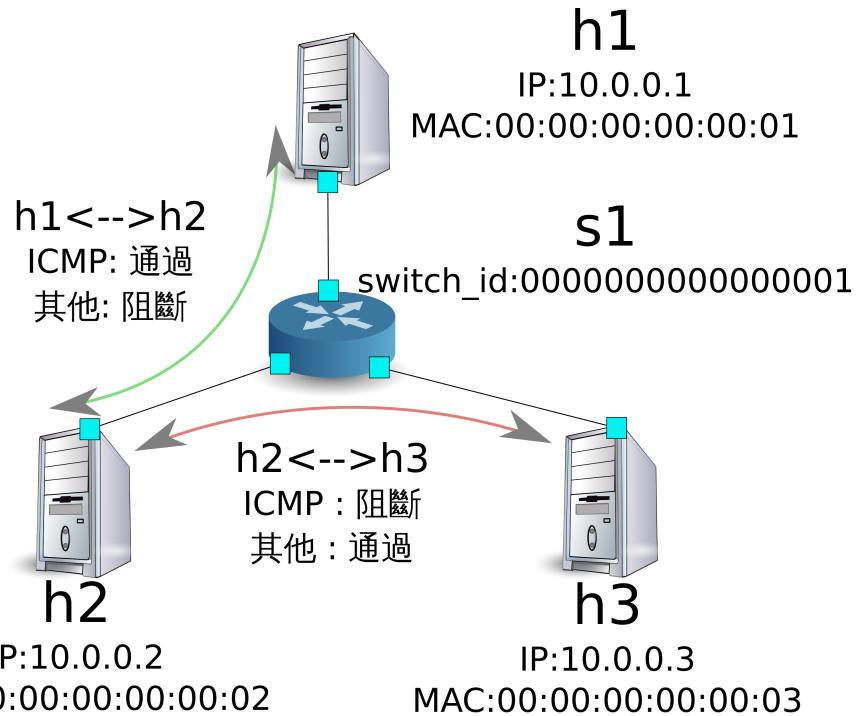
從 h1 向 h2 執行 ping。如果允許的規則有被正確設定的話，ping 就可以正常連線。
