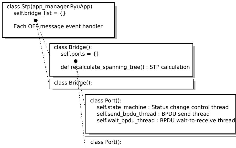
STP 函式庫 (STP 實體) 偵測到 OpenFlow 交換器和 Controller 已經連結時，Bridge 類別的實體和 Port 類別的實體就會被產生。
