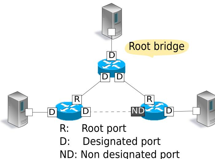
備註： 每一個連接埠到 Root 橋接器的距離是基於收到 BPDU 中的設定值，並加上下列的比較計算出來。
